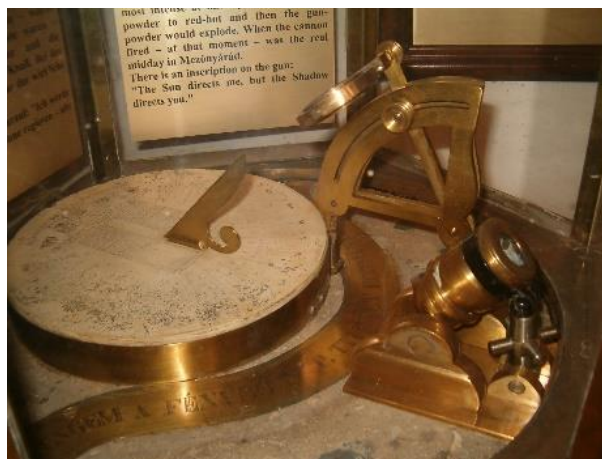
Mezőnyárádi ágyús napóra (jobbra) és a vízszintes helyzetű horizontális napóra (balra)
