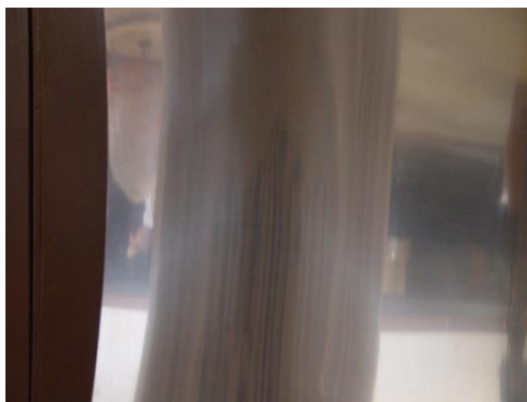
36. sz. kép Homorú hengertükör képalkotása, tárgy a gyújtópontban
