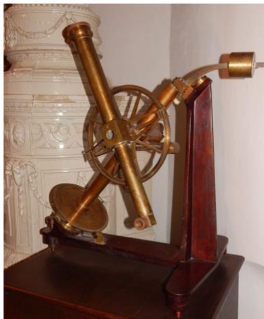
8. ábra: Angol szerelésű parallaktikus távcső
