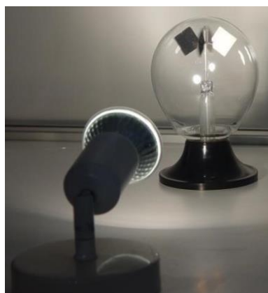
13. sz. kép Crookes-féle radiométer
